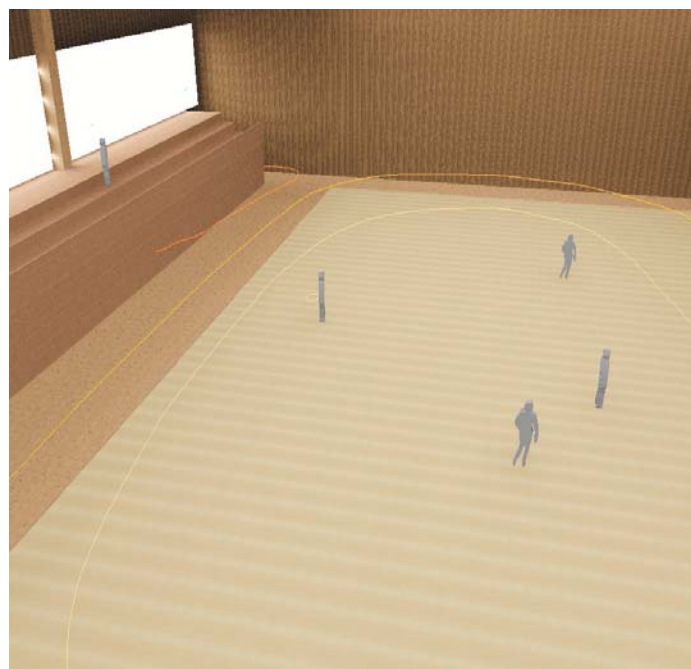
Visualizaciones del efecto de la luz y curvas isolux de los niveles de iluminación natural
