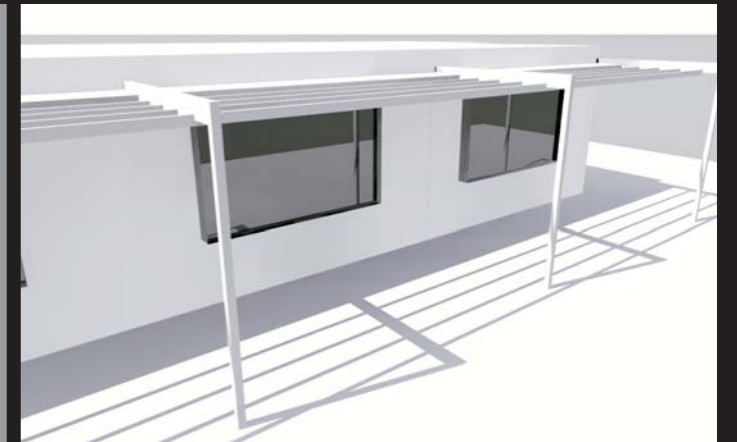
Protección solar sobre las fachadas
